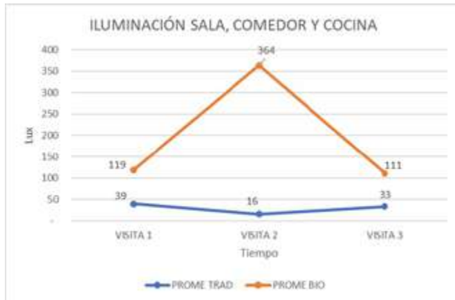
Gráfica 5. Comparación de iluminación en sala, comedor, cocina entre vivienda tradicional y climática. Fuente. Elaboración propia.
