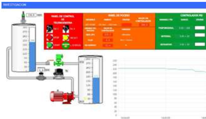
Fig. 9. Dashboard del proceso industrial de flujo y nivel creado en la plataforma industrial VNET.
