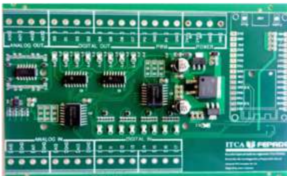
Fig. 4. PCB del controlador electrónico. Los componentes electrónicos SMD fueron soldados de fábrica.
