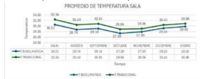
Gráfica 1. Promedios de temperatura de sala casa tradicional y bioclimática. Fuente. Elaboración propia.
