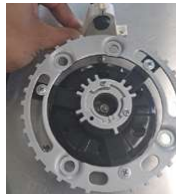
Fig 2. Base de porta sensores y reductor diseñado.
