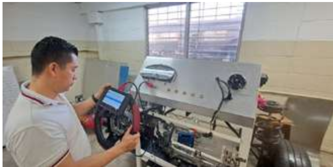
Fig. 3 Pruebas de interacción del equipo con un escáner automotriz.
