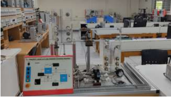
Fig. 2. Entrenador físico de control de flujo y nivel, FPC.
