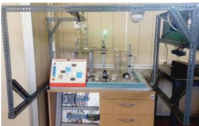
Fig. 10. Estructura para montaje de cámaras y dispositivos de red de datos del entrenador.
