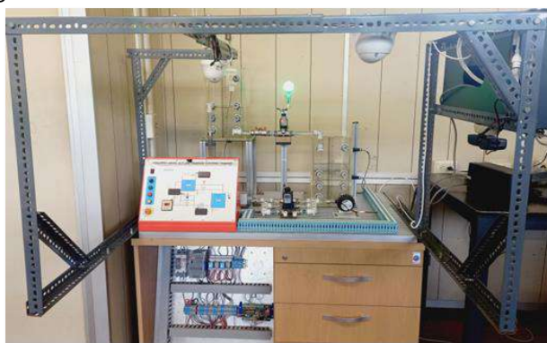
Entrenador FPC real que se controla de forma remota a través de una plataforma de teleingeniería.
