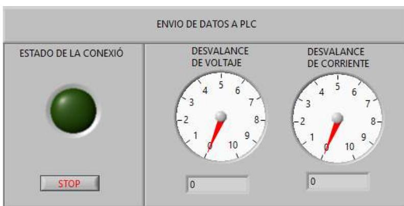
Fig. 21: Módulo para compartir datos con un PLC S7 1200.
