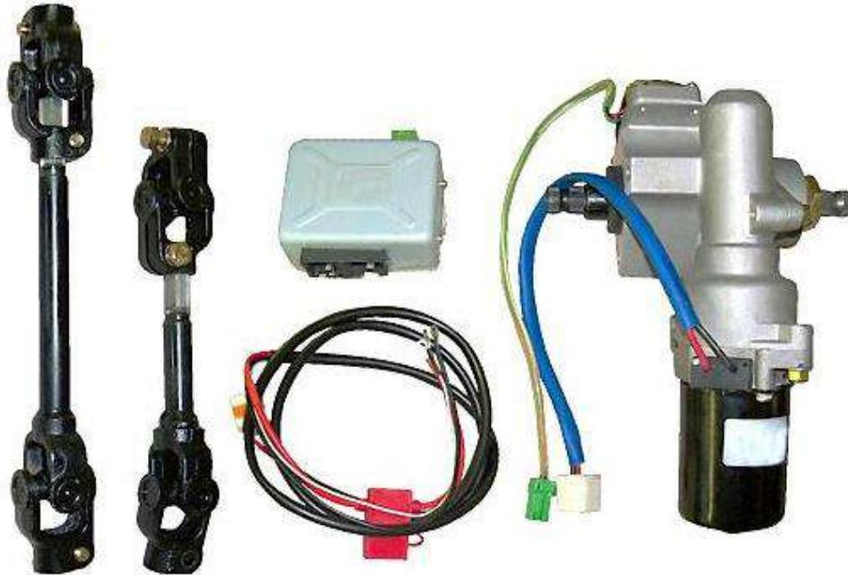
Fig. 16. Ejemplo de componentes básicos del sistema EPS.
