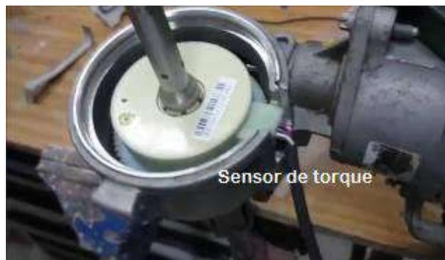
Fig. 19. Ubicación del sensor de torque.
