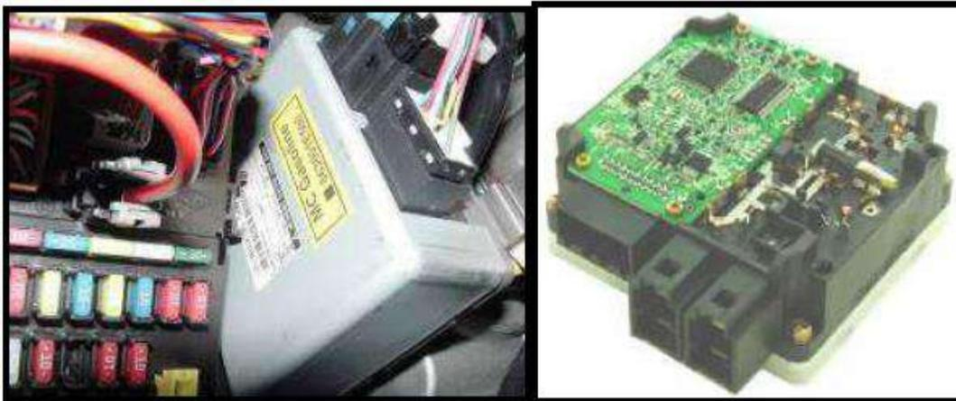
Fig. 22. Módulo de control de EPS.
