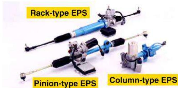
Fig. 12. Tipos de dirección eléctrica.
