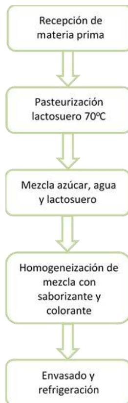
**Figura 6.** Diagrama de proceso para la elaboración de bebida hidratante con base de lactosuero.
