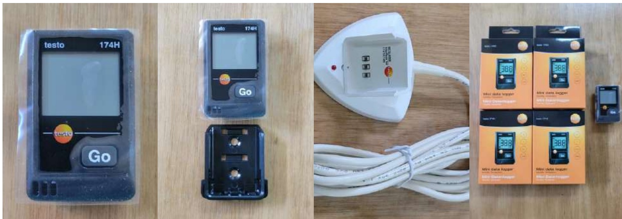
Figura 22. Datalogger marca testo modelo 174H e interfaz de descarga. Fuente. Elaboración propia.
