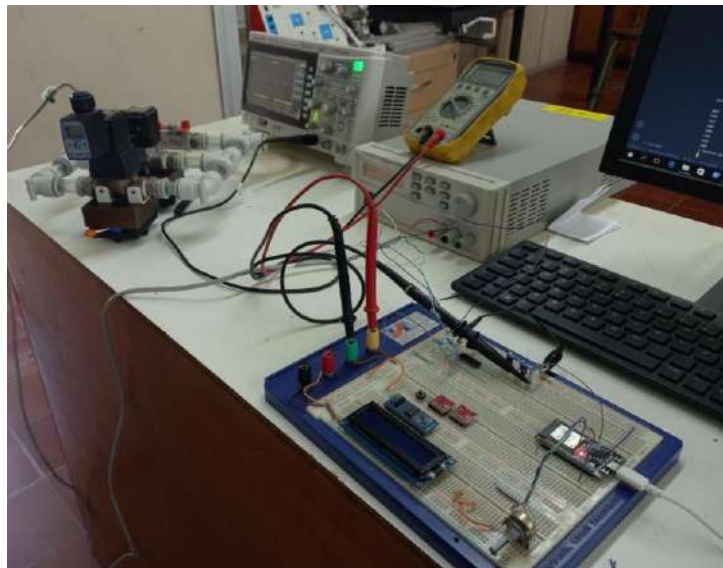
Fig. 17. Banco de pruebas de funcionamiento del circuito de control de la válvula proporcional.
