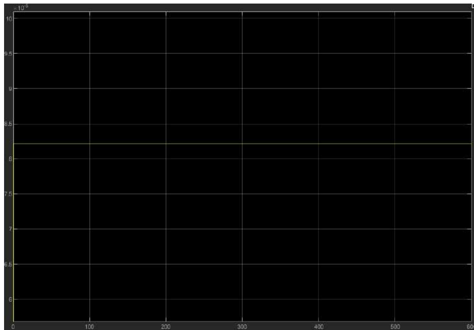
Gráfica. 4. Resultados de la simulación del proceso de flujo y nivel, se puede observar que el flujo se estabiliza en aproximadamente 0.0000825 \text{ m}^3/\text{s} .
