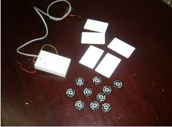
Equipo RFID pasivo a utilizar en la aplicación de control de acceso y asistencia. Muestra el lector de RFID GP30, World tag y tarjetas de proximidad de 125 KHz.
