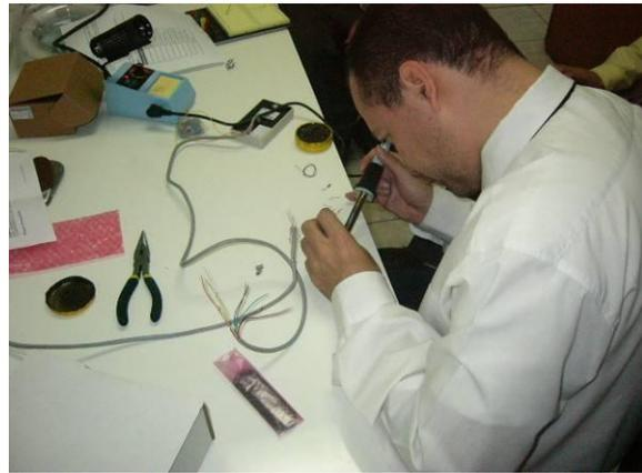
Incorporación de cable USB para alimentación eléctrica del lector de RFID pasivo a través de la computadora donde será conectado.
