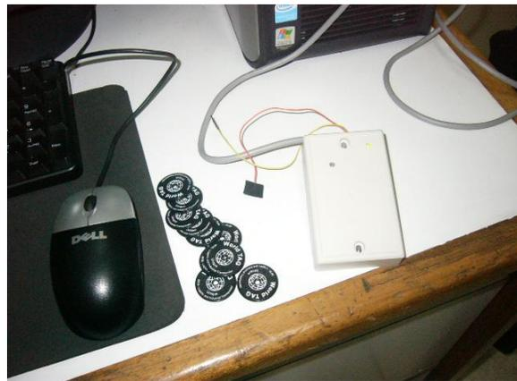
Pruebas de funcionamiento del lector de RFID pasivo, conectado al equipo de cómputo y al software para el control de acceso y asistencia.
