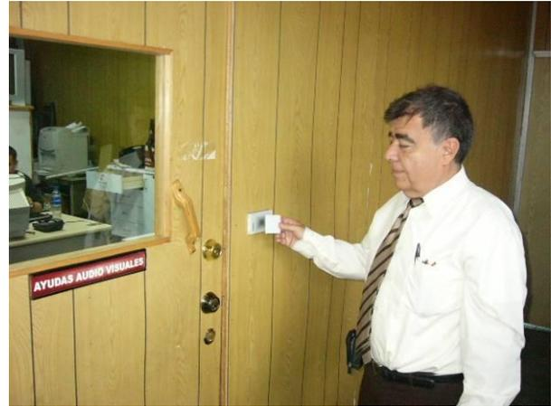
Lector RFID pasivo para el control de acceso y software instalado en el salón de audiovisuales.
