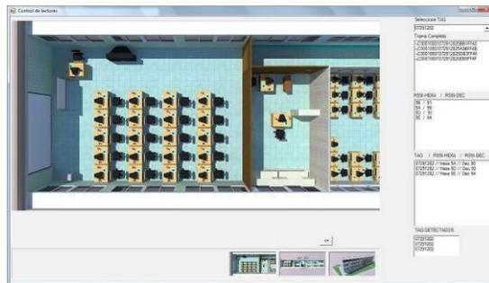
Prototipo de software elaborado en Visual Basic .Net para conocer los indicadores: RSSI, LQI y carga de la batería de los tag de RFID, lo que es utilizado para determinar la ubicación idónea de cada lector de RFID
