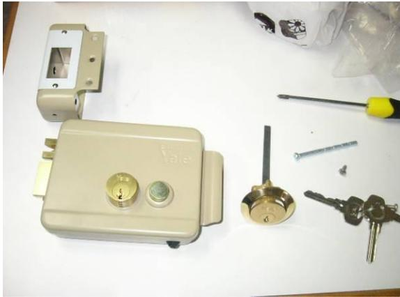
Componentes de la chapa eléctrica a instalar la puerta de acceso del salón de equipos audiovisuales del edificio F de sede central, para la aplicación de control de acceso y asistencia con tecnología RFID pasiva.
