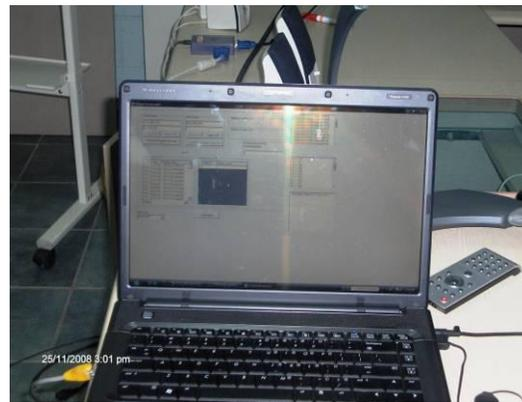
Prototipo de software elaborado en Visual Basic .Net para conocer los indicadores: RSSI, LQI y carga de la batería de los tag de RFID, lo que es utilizado para determinar la ubicación idónea de cada lector de RFID
