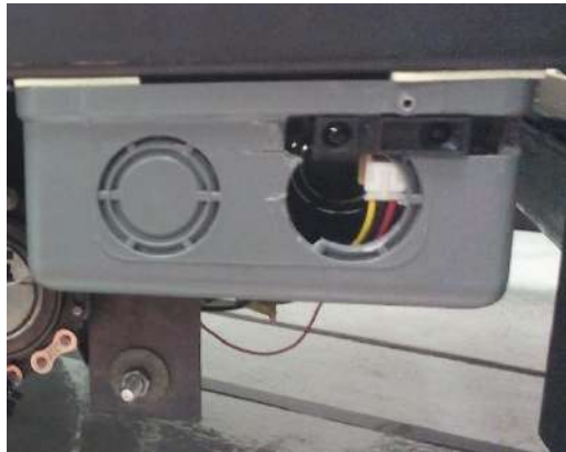
Fig. 30: Sensor IR montado en AGV
