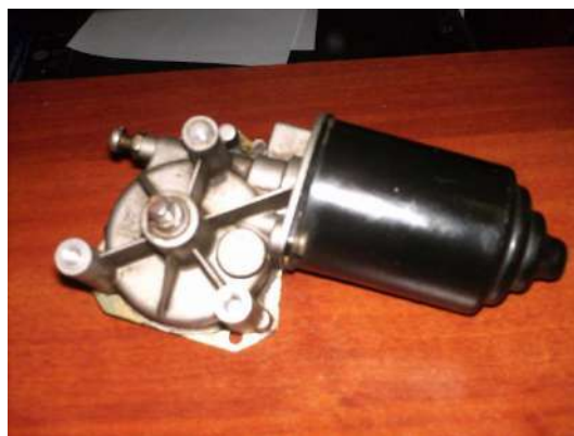
Fig. 5: Motores DC a 12 V, 80 W
