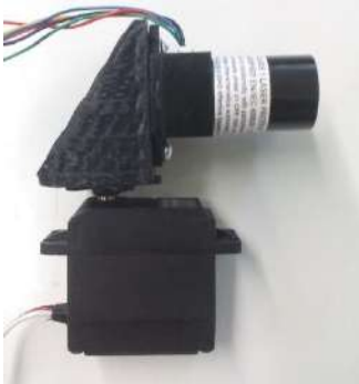
Fig. 22: Sensor LIDAR con Servomecanismo Fig. 23: Sensor LIDAR instalado a un costado del AGV
