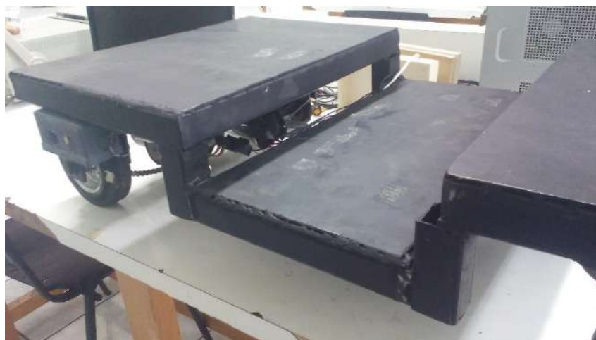
Fig. 8: Área central del chasis, espacio para demás componentes
