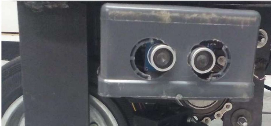
Fig. 29: Sensor ultrasónico montado en AGV
