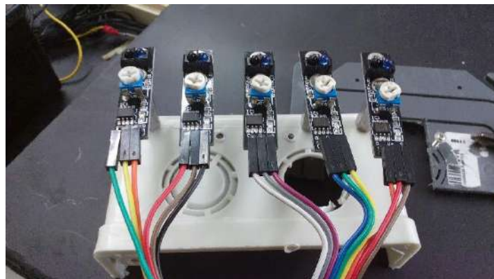
Fig. 31: Sensor IR montado en estructura plástica
