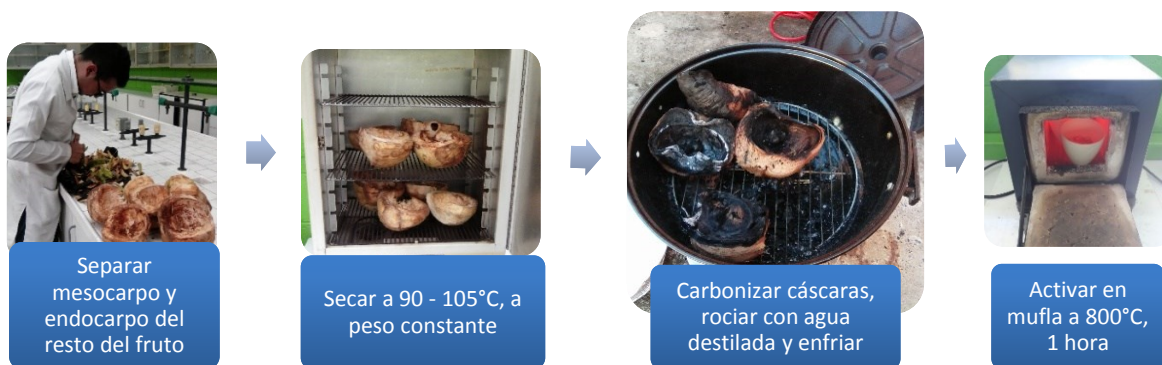
Figura 13. Proceso de elaboración de carbón activado a partir de mesocarpo y endocarpo de coco. Fuente: Elaboración propia.
